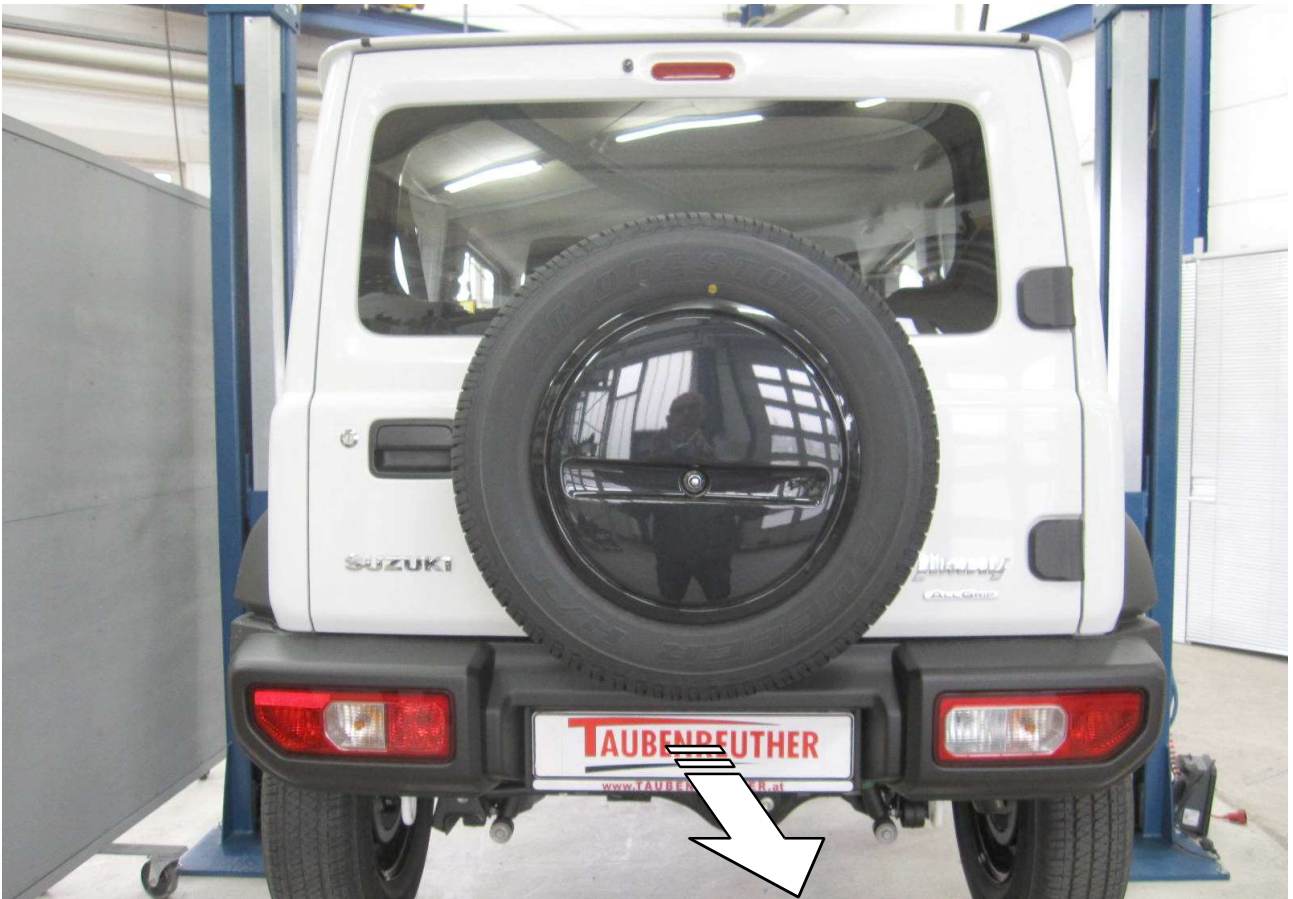
1 Stoßfänger entfernen! Remove the bumper!
