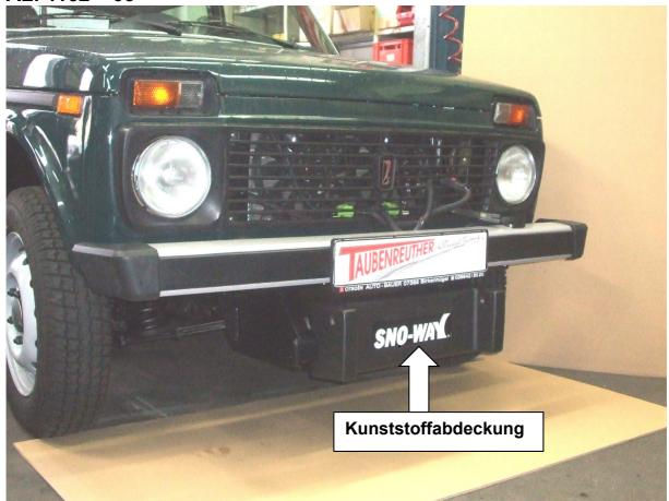
Hier sehen sie den fertig montierten Schneepflugabstützsatz. Bevor sie mit der Montage beginnen lesen sie bitte diese Anleitung gut durch.
