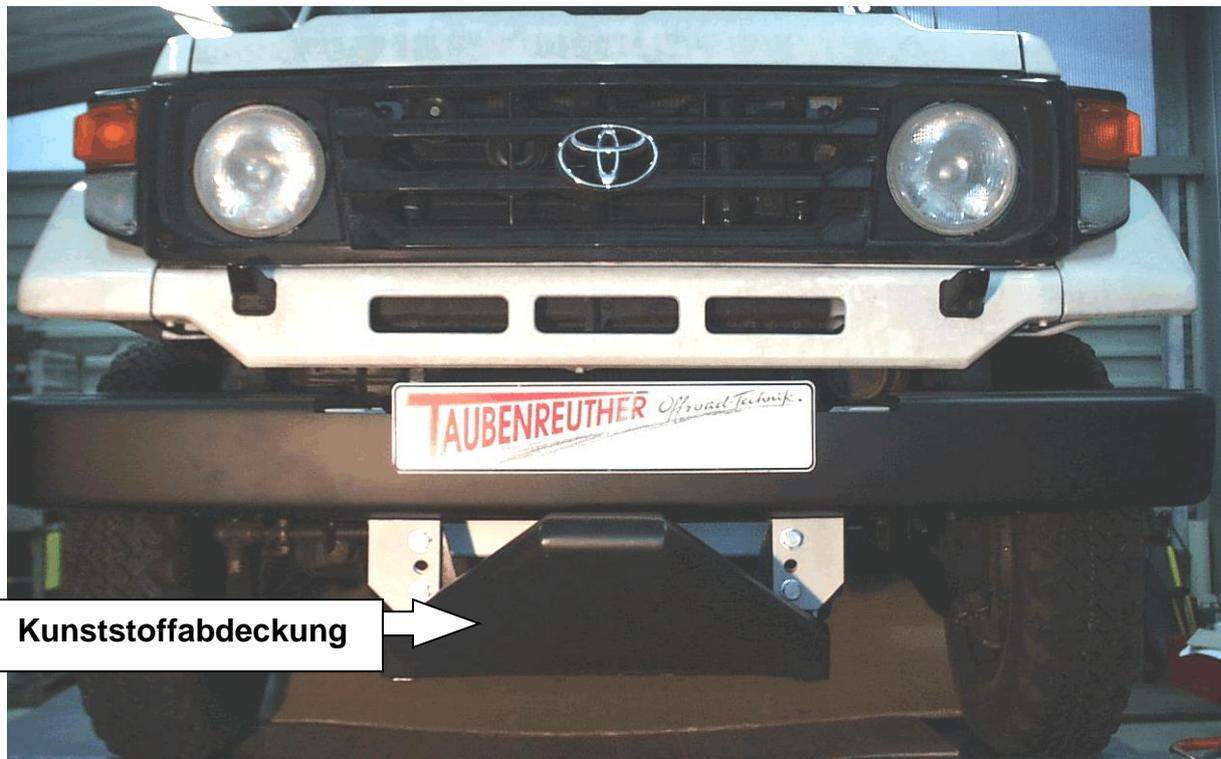
Hier sehen sie den fertig montierten Schneepflugabstützsatz.
