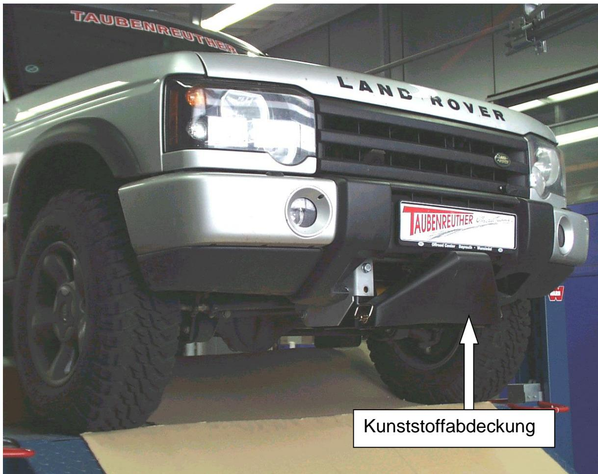
Hier sehen sie den fertig montierten Schneepflugabstützsatz.
